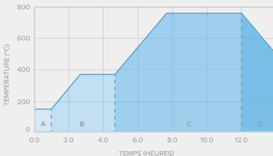
Le cycle de brûlage standard est conçu pour que le produit de moulage soit le plus solide possible et qu'il permette le brûlage des moindres détails en employant R&R Plasticast ou tout autre produit de moulage similaire.
