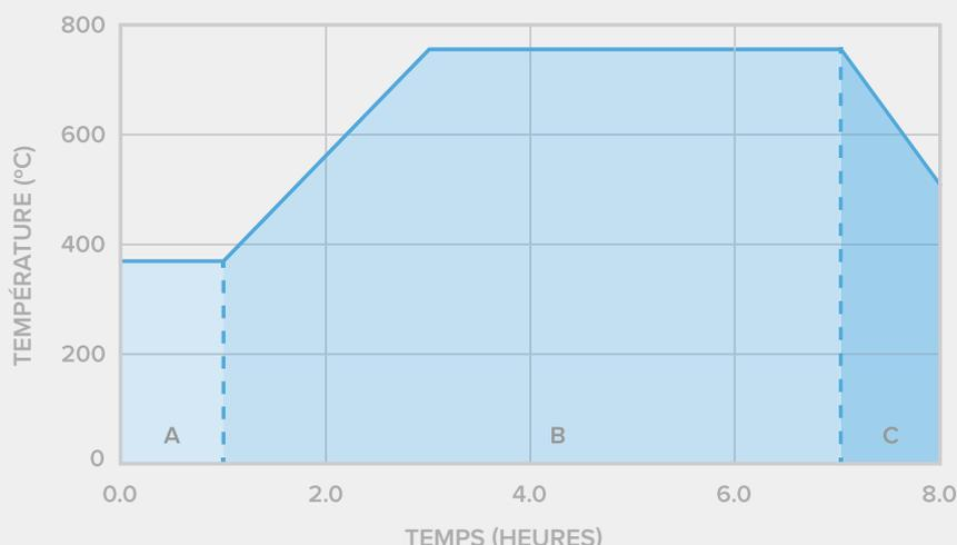
Il est possible de raccourcir ce cycle pour certaines géométries de pièces et produits de moulage. Des produits haut de gamme, comme le R&R's Ultravest Maxx, sont plus solides et peuvent supporter des cycles de montée en température plus rapides.
